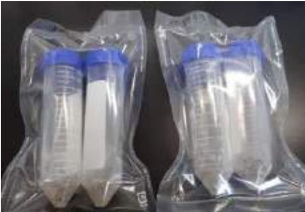
図 1. 酸化マグネシウム混合土の養生の様子。
